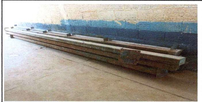
Foto 6: Se observa el material retirado del techo en estado oxidado y dañado.
